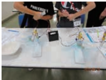
備長炭電池の実験。2つを直列につなぎ、メリーゴーランドを高速回転させたよ！
