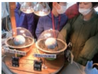
二酸化炭素の温室効果実験。赤外線ランプで加熱し、温度上昇を確認しました。
