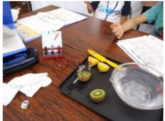
食塩を水に溶かし、食塩水を作り、その中に電極を入れて電圧を測ります。つぎに、レモン、キューイフルーツを半分に切り、その中に電極を入れて、電圧を測ります。
