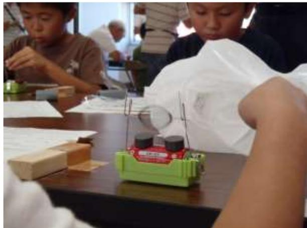
クリップモーターで作ったコイルをプラスチックコップの底に張り付け、スピーカーになることを実験しました。
