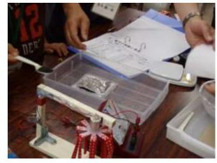
銅とアルミニュウムの他、銅と亜鉛、鉄とアルミニュウムの組み合わせでも電池が作れることを実験し、実験結果をボードにまとめました。アルミフォイルと活性炭でも電池が作れることを体験しました。
