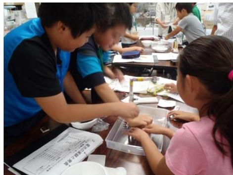
次は、アルミニウム фольと活性炭を使った電池の実験です。アルミ фольの上に活性炭を巻き、その上に食塩水で湿らせたキッチンペーパーを敷き、その上にアルミ фольを載せ、アルミ фольに線をつなぐと電池ができました。アルミ фольのサンドイッチを2～4枚とすると電圧が上がり、メリーゴーランドを勢いよく回すことができました。
