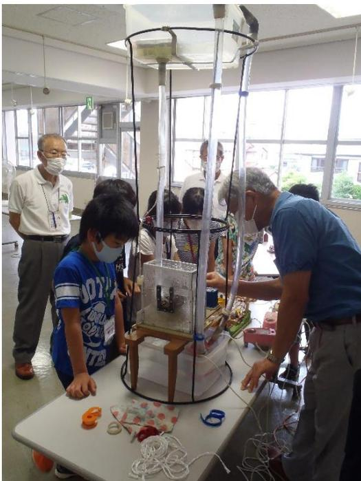
コイルの中に磁石を入れたり出したりすると、電気が生まれることを体験し、それを利用して発電機が作られていることを学びました。発電機を動かして電気を作るために水の落ちてくる時の力や風の力を使い、たくさんの電気が出ることが分かりました。
