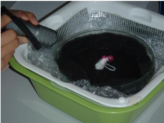
シャーレの縁にスポンジを置き、スポンジにアルコールを含ませ、アルコールの蒸気をシャーレに満たします。シャーレの底をドライアイスで冷やしていると中心に置いた放射線源から出る放射線が白い細い線となって見えてきます。これは、寒い晴れた空にできる飛行機雲と同じで、アルコールの蒸気が放射線の飛跡を作ります。
